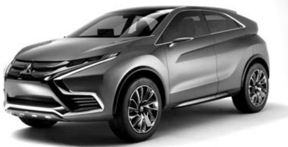
Après un premier concept du même nom à Genève 2014, Mitsubishi revient en Suisse avec cette version II du XR-PHEV. Proche de la réalité, ce petit crossover est mû par un moteur électrique de 163 ch transmettant sa puissance aux roues avant et alimenté en énergie par un bloc thermique traditionnel. De quoi annoncer environ 40 g/km de CO2.
